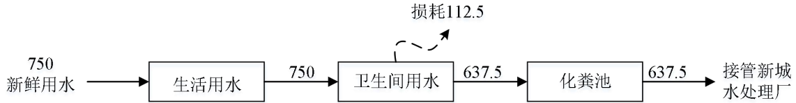
图 2-3 本项目 35-312 号厂房水平衡图 单位：t/a
